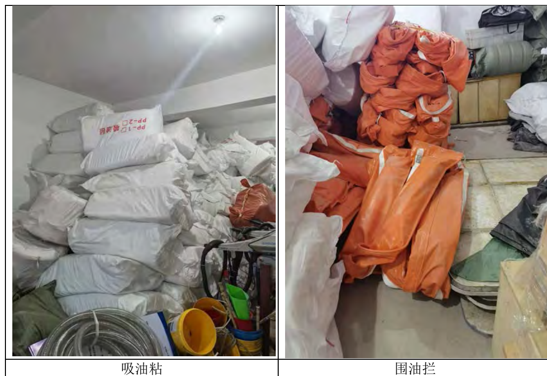
图 2.3-1 溢油应急设施
